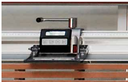
Sistema de medição digital DMS – medir com precisão de 1/10 mm.
