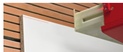
Indicador laser do corte horizontal (de série)
